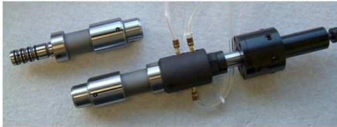
Calibre para máquinas, de troca rápida com suporte pendular
