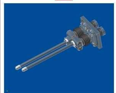
Calibre para máquinas, para perfuração da árvore de cames em 3D
