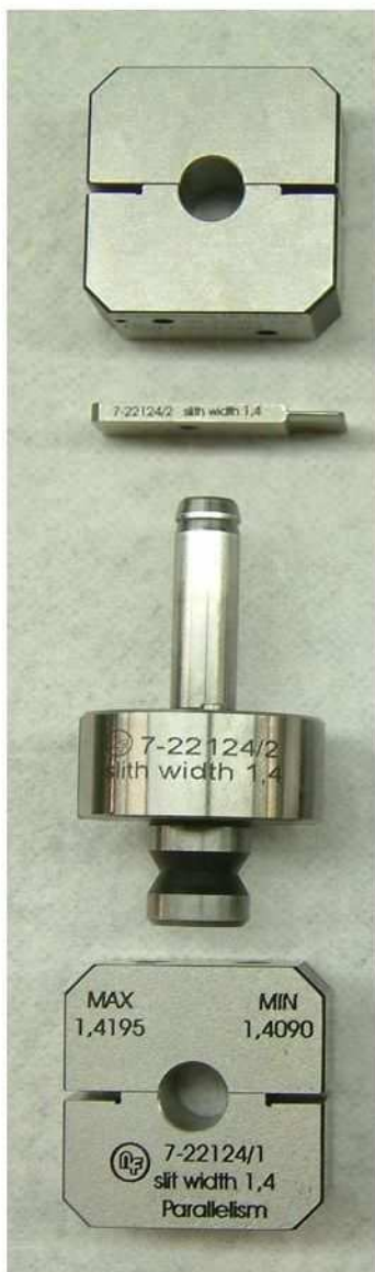
Rápida adaptação através de jogos de substituição.
