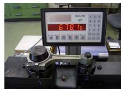
Pesagem do olhal maior e menor separadamente, inclusive transferência dos dados para o processador de medição.
