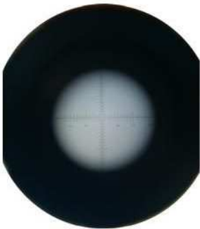
A leitura da largura da sede da válvula efectua-se através de uma escala óptica no ocular
