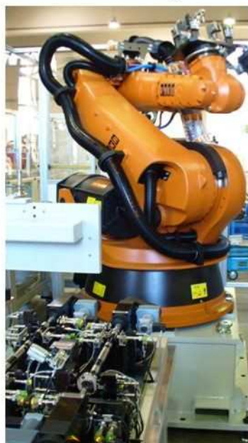
As peças são colocadas por um robô na instalação de medição
