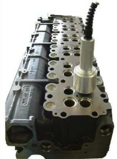
Medição da rectilidade da sede da válvula numa cabeça de cilindro de um camião
