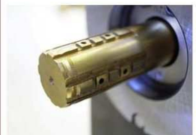
Revestimento TiCN para longa vida útil
