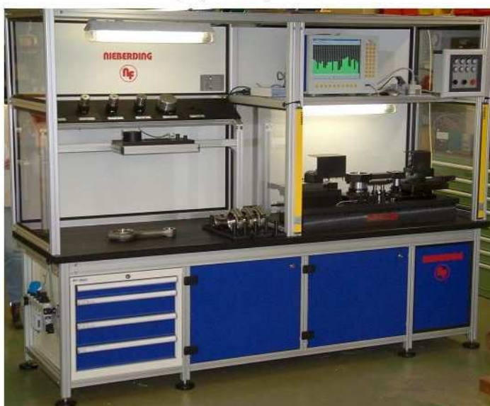
Dispositivo de medição SPC para bielas, com possibilidade de adaptação a 9 tipos de biela
