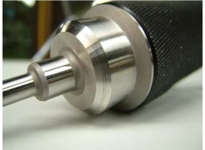
Medição da estanquidade na válvula através de bocais anelares
