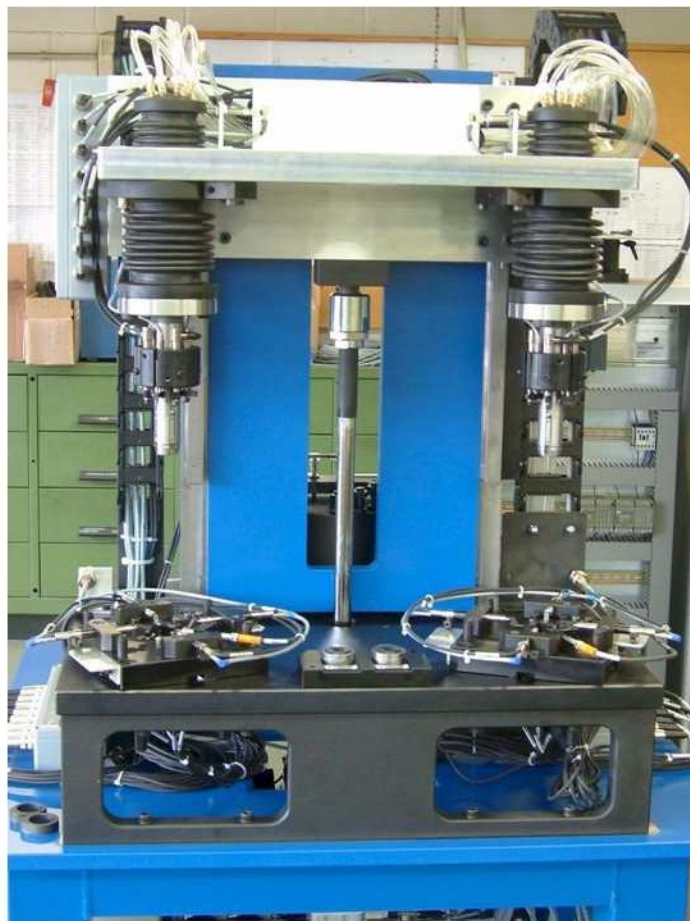
Medição de cames: Ciclos de 4 segundos
