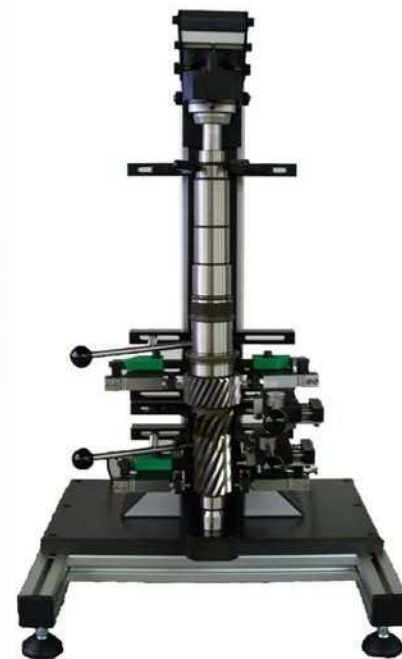
Dispositivos simples e flexíveis para medição de eixos e eixos de transmissão na produção.
