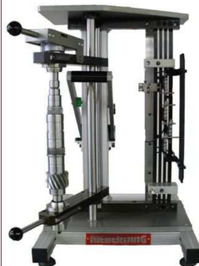
Dispositivos simples e flexíveis para medição de eixos e eixos de transmissão na produção.
