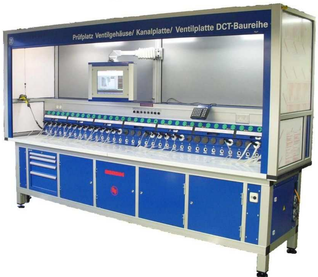
Posto de medição SPC para medir carcaça da válvula e canais da placa
