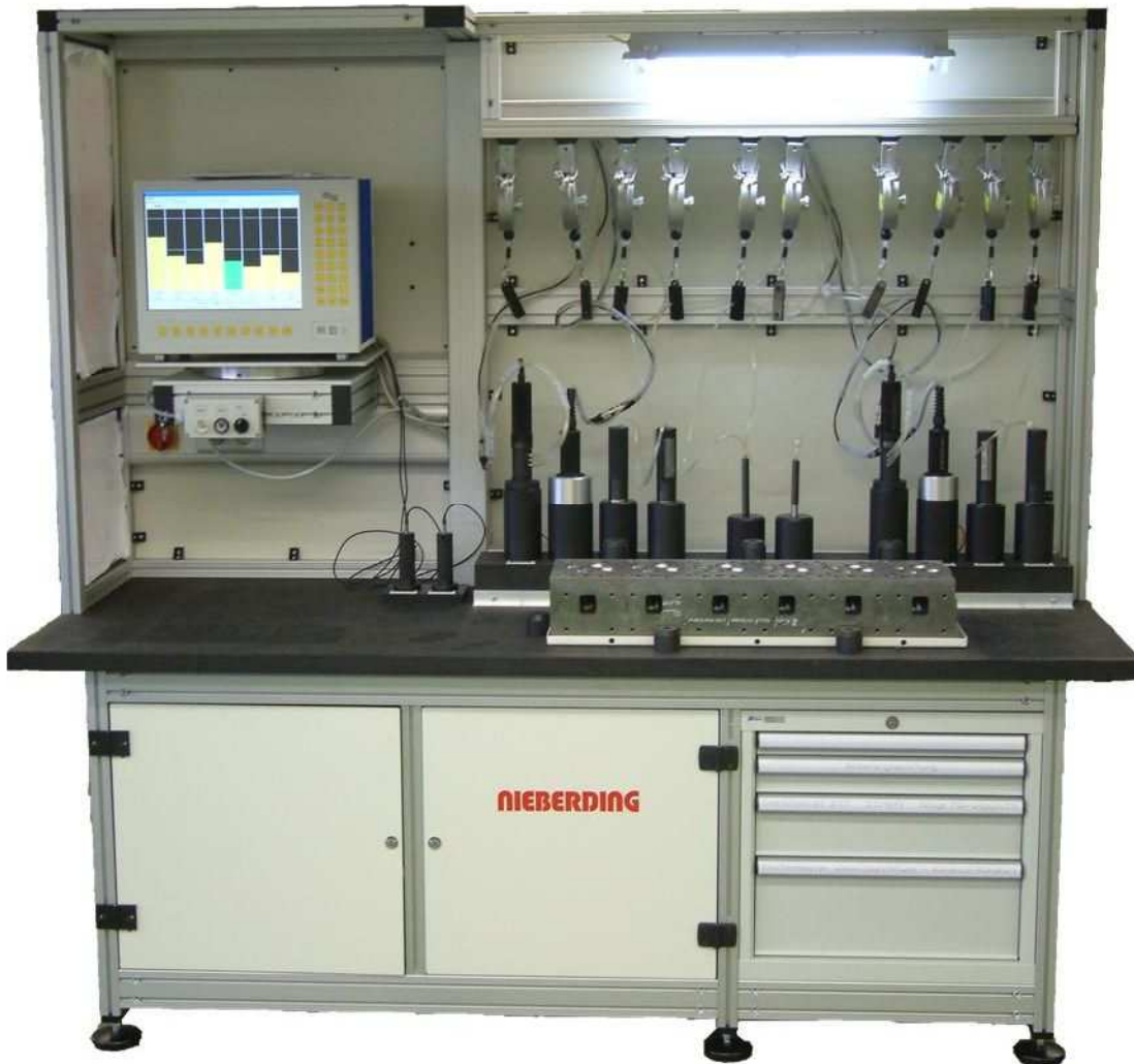
Medição da rectilidade da sede da válvula numa cabeça de cilindro de um camião
