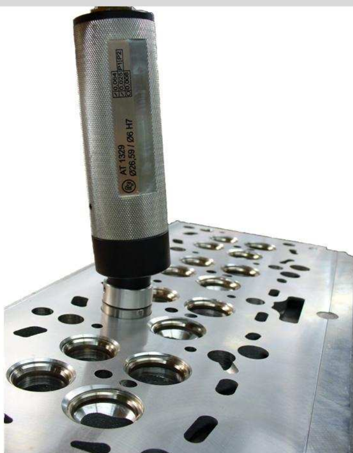
A ogiva de medição é de fácil manuseio e trabalha de forma confiável
