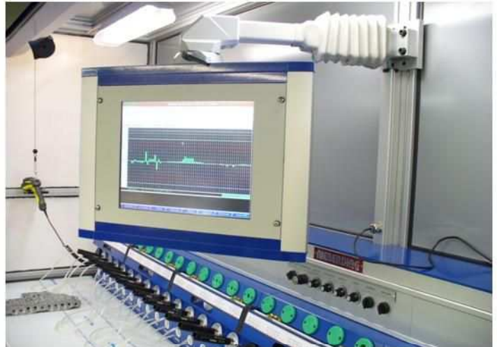
Detalhe: Estação de medição com monitor "touch screen" de 17" polegadas
